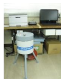
放射性物質測定装置(Nal シンチレーションスペクトロメーター)
