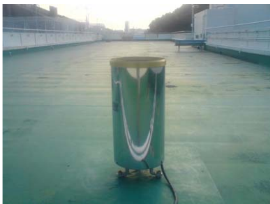
【雨量計：市役所屋上に設置】
