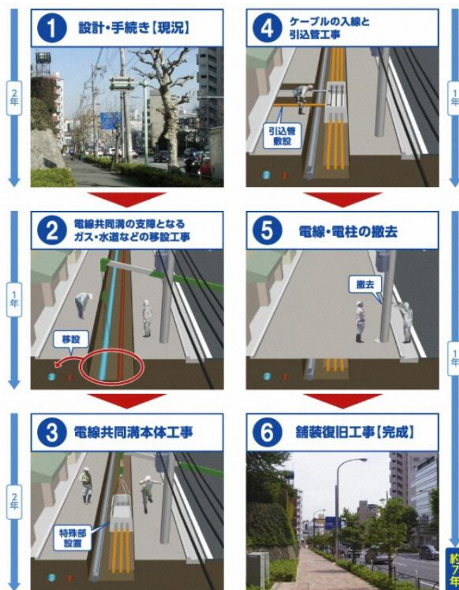
図-7 電線共同溝方式の工事手順
