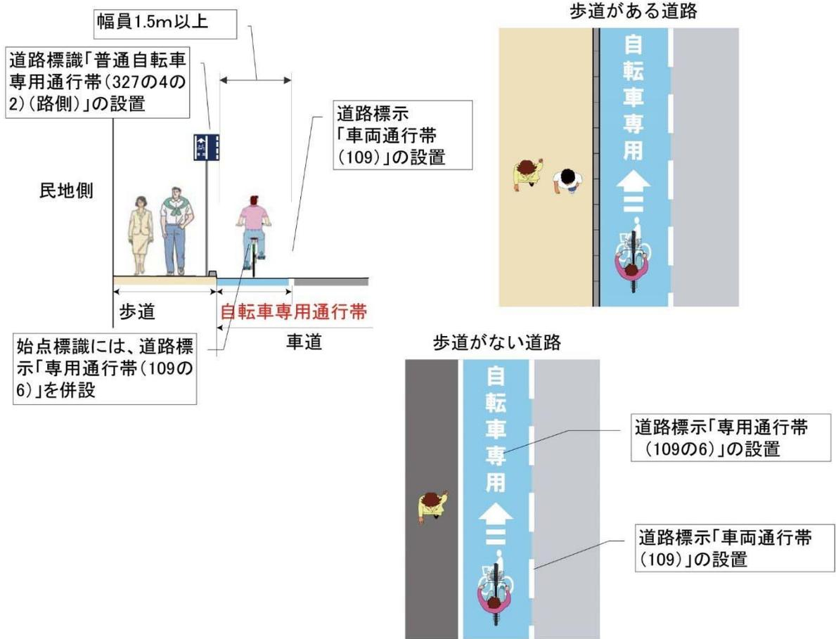
図 5.6 「B. 自転車専用通行帯」の整備イメージ
