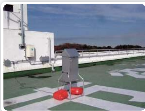
ダイオキシン類調査の様子 (市役所屋上)
