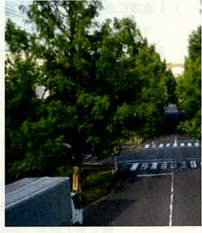
信号機の視認障害
