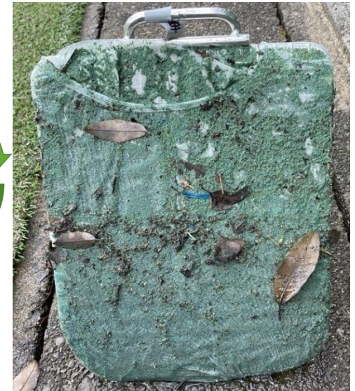
降雨後にMPsが付着、交換
