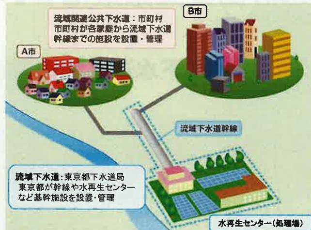
※ 幹線とは、大量の下水を集めて水再生センターへ流下させる下水管網の骨格をなす管です。
